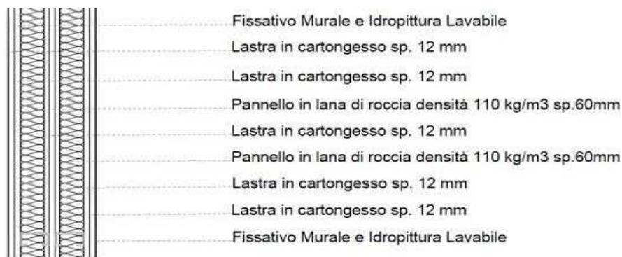
Figura 2 – Sezione delle pareti interne
